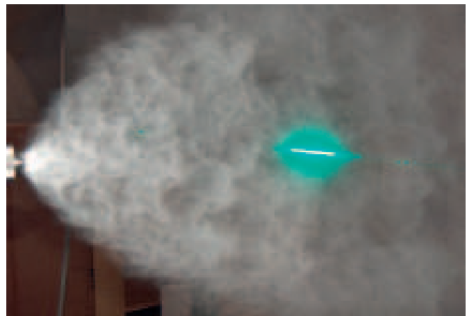
Die Zweistoffdüse mit Flachstrahlcharakteristik verteilt das Reduktionsmittel gleichmäßig und großflächig im Abgaskanal
