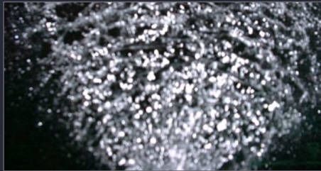
Spray einer Druckdüse mit Flachstrahlcharakteristik
